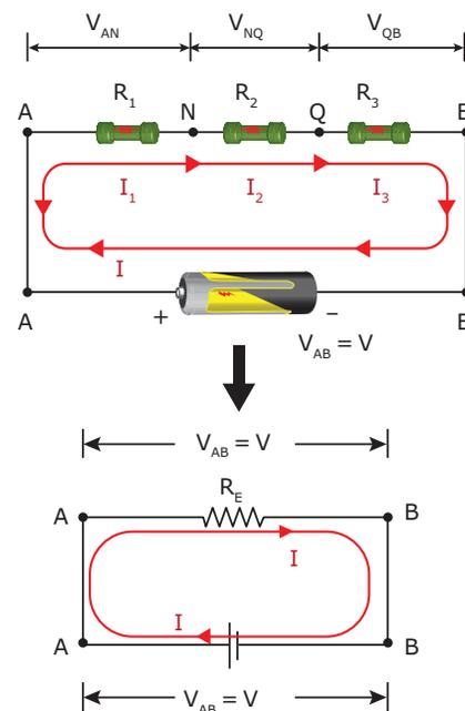
Observe que a corrente que percorre o circuito tem um único caminho para passar (seja na bateria, no resistor equivalente ou nos resistores da associação). Portanto, concluímos que os resistores estão ligados em série.
