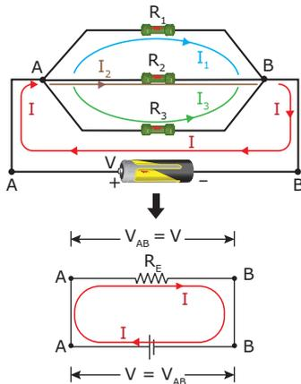
Veja que os três resistores têm as suas extremidades ligadas diretamente aos terminais da bateria (pontos A e B). Dessa forma, todos os resistores estão submetidos à mesma voltagem ( $V_{AB}$ ). Logo, podemos concluir que os três resistores estão associados em paralelo. Veja que, nesse caso, a tensão em qualquer um dos resistores é igual à voltagem fornecida pela fonte.
