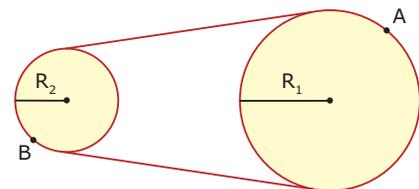
No acoplamento por correia, temos que  $v_1 = v_2$ . Observando a figura, podemos concluir que  $R_1 > R_2$ . Como  $a_c = v^2/R$  e sendo  $v_1 = v_2$ , temos que a aceleração centrípeta é inversamente proporcional ao raio da polia. Logo, como  $R_1 > R_2$ , temos que  $a_{c1} < a_{c2}$ .
