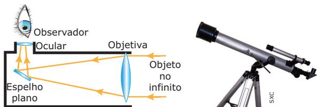
O binóculo e o periscópio, citados como aplicações da reflexão total, formam imagens da mesma maneira que um telescópio refrator.
