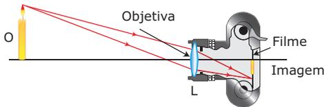
Na parte frontal de uma câmera, existem dois dispositivos – o diafragma e o obturador –, cujas funções são, respectivamente, controlar a quantidade de luz que entra na máquina e abrir e fechar a câmera para permitir a execução da fotografia. Ou seja, a máquina fotográfica é uma câmara escura que projeta na parede oposta (filme) a imagem formada pela luz que entra pelo orifício (diafragma).
