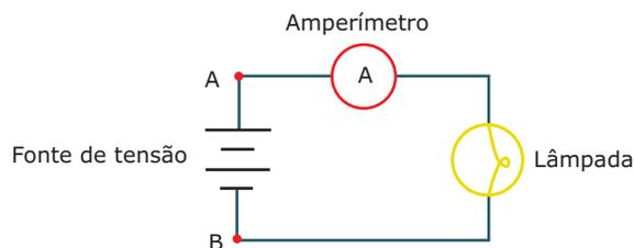
Figura 1: Montagem para medição da corrente elétrica.
