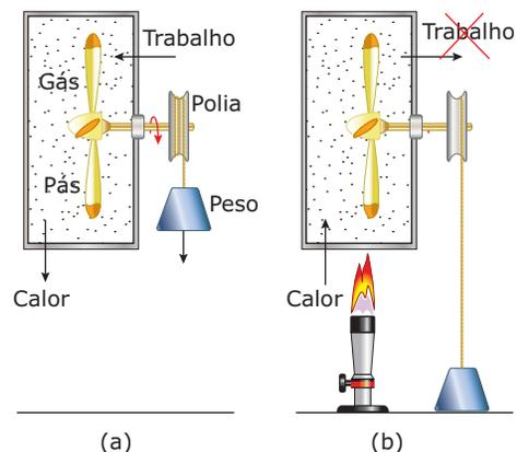
Figura 1: (a) Ciclo possível: conversão integral de trabalho em calor; (b) ciclo impossível: conversão integral de calor em trabalho.
