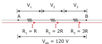
Já que os resistores estão associados em série, a corrente é a mesma em todos eles, e as tensões em cada um se somam para formar a voltagem total. Sabe-se que  $V = RI$  e, assim, a tensão em cada um dos resistores é diretamente proporcional à sua resistência (a corrente elétrica é a mesma). Portanto:
