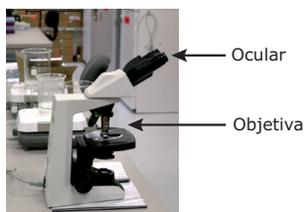
O objeto a ser observado em um microscópio deve ser colocado a uma distância da objetiva que seja maior que a distância focal dela, mas próximo ao foco. A objetiva forma uma imagem real ( $I_1$ ), invertida e ampliada do objeto.
