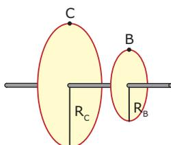
Isso significa que a frequência do movimento descrito pela roda C também será de 4 Hz. A relação  $v = 2\pi Rf$  nos mostra que, sendo a frequência constante,  $v \propto R$ . Logo, como o ponto C está a uma distância dezesseis vezes maior do eixo que o ponto B, sua velocidade linear será dezesseis vezes maior que a do ponto B, ou seja,  $v_C = 3,2\pi$  m/s.
