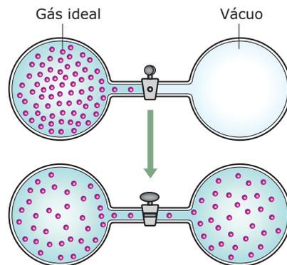
Figura 6: Exemplo de uma expansão livre.
