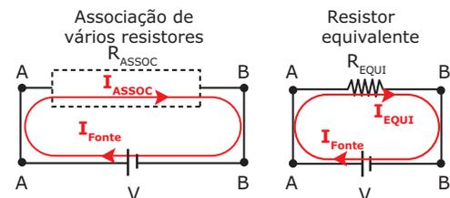
Observe, na figura anterior, que as fontes, a associação de resistores e o resistor equivalente estão ligados, diretamente, aos pontos A e B. Sejam  $V$  = voltagem;  $I$  = corrente;  $R$  = resistência e  $P$  = potência dissipada. Em qualquer tipo de associação de dois (ou mais) resistores, há características que são comuns a todas as associações e que, portanto, precisamos conhecer; são elas:
