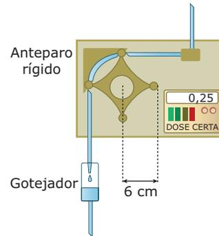
Regulando-se o aparelho para girar com frequência de 0,25 Hz, pequenos roletes das pontas da estrela, distantes 6 cm do centro desta, esmagam a mangueira flexível contra um anteparo curto e rígido, fazendo com que o líquido seja obrigado a se mover em direção ao gotejador. Sob essas condições, a velocidade escalar média imposta ao líquido em uma volta completa da estrela é, em m/s,
