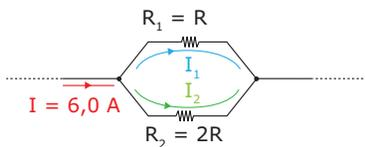
Observe, na figura, que  $R_1 = R_2/2$ . Uma vez que eles estão em paralelo, as voltagens são iguais e as correntes que atravessam cada um deles se somam para formar a corrente total. Sabemos que  $I = V/R$ , e, portanto, a corrente em cada resistor é inversamente proporcional à sua resistência (a voltagem é a mesma para os dois).
