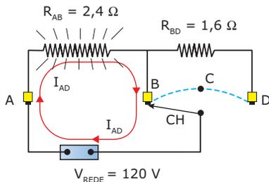
A chave (CH), dessa vez, foi conectada ao ponto B. A corrente atravessa, apenas, o resistor  $R_{AB} = 2,4 \Omega$ , que, nesse caso, é a resistência do chuveiro. Assim,  $I_{AB} = V_{AB}/R_{AB} = 120/2,4 = 50 \text{ A}$ . Observe que a corrente que percorre o chuveiro aumentou em relação à situação anterior. Assim, apesar de a resistência ter diminuído, a potência dissipada vai aumentar,  $P_{AB} = V_{REDE}^2/R_{AB} = 120^2/2,4 = 6\,000 \text{ W}$ . Agora vai sair fumaça!
