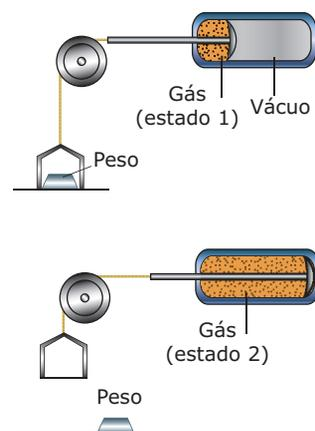
Figura 6: A expansão livre é um processo irreversível.
