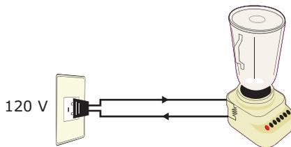
Se os fios que alimentam o liquidificador fazem contato um com o outro (por exemplo, se o plástico em volta dos fios derreter), eles fecham um curto-circuito nesse ponto. A corrente vai passar por um circuito mais "curto" – apenas nos fios de ligação, conforme mostrado a seguir.
