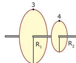
No acoplamento por eixo, temos que  $\omega_3 = \omega_4$ . A partir da figura, podemos concluir que  $R_1 > R_2$ . Sendo  $v = \omega R$ , temos que  $a_c = v^2/R = (\omega R)^2/R = \omega^2 R$ . Como  $\omega_3 = \omega_4$ , temos que a aceleração centrípeta será diretamente proporcional ao raio das polias. Logo, sendo  $R_1 > R_2$ , temos que  $a_{c3} > a_{c4}$ . Dessa forma, a alternativa correta é a B.
