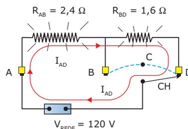
A chave (CH), agora, está ligada ao ponto D, e a corrente percorre os resistores  $R_{AB}$  e  $R_{BD}$ . A voltagem fornecida ao dispositivo é  $V_{REDE} = 120 \text{ V}$ , e a "resistência do chuveiro" vale  $R_{AD} = 4,0 \Omega$ . Logo, a corrente que percorre o aparelho é  $I_{AD} = V_{AD}/R_{AD} = 120/4,0 = 30 \text{ A}$ . O chuveiro dissipa, então, uma potência  $P_{AD} = V_{REDE}^2/R_{AD} = 120^2/4,0 = 3\,600 \text{ W}$ . O banho começou a esquentar!
