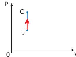
Esse processo ocorre quando, no instante da queima da mistura ar-gasolina contida na câmara de combustão, fornece-se calor ao sistema, produzindo-se
