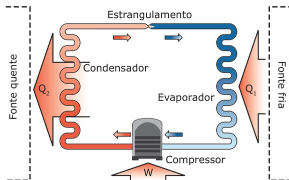
Figura 5: Esquema de um refrigerador.
