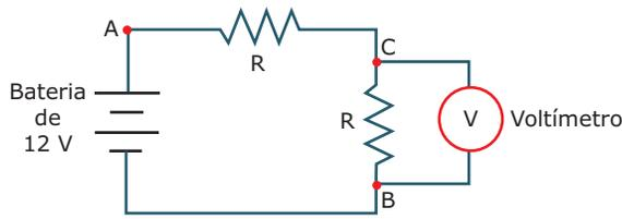
Figura 2: Montagem para medição da tensão elétrica.
