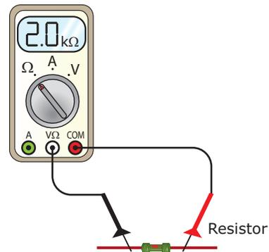
Figura 3: Medição da resistência elétrica.
