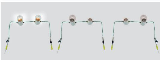
Observe que, se qualquer uma das lâmpadas for desligada do circuito, queimar ou quebrar, a corrente ficará impedida de passar por ela (existe um único caminho para ela circular) e nenhuma das lâmpadas acenderá.
