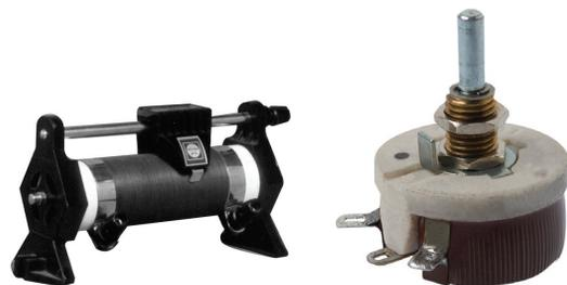
O funcionamento do reostato é simples e baseado no fato de que a resistência varia com o comprimento do resistor a ser percorrido por uma corrente ( $R \propto L$ ). O potenciômetro deve ser ligado em série com o aparelho cuja corrente se quer controlar (ele vai dividir a voltagem com o dispositivo – divisor de tensão).
