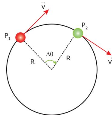
A figura anterior mostra uma partícula, em movimento circular, passando por uma posição  $P_1$ , em um instante  $t_1$ , e por uma posição  $P_2$ , em um instante  $t_2$ . Nesse intervalo de tempo,  $\Delta t$ , o ângulo central variou de  $\Delta\theta$ . Definimos a **velocidade angular ( $\omega$ )** como a razão entre  $\Delta\theta$  e  $\Delta t$ :
