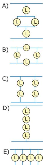
**11.** (PUC RS-2006) Um electricista tem uma tarefa para resolver: precisa instalar três lâmpadas, cujas especificações são 60 W e 110 V, em uma residência onde a tensão é 220 V. A figura a seguir representa os três esquemas considerados por ele.
