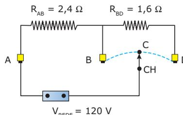
A rede elétrica fica ligada entre o ponto A e a chave seletora de temperatura. Na figura anterior, a chave (CH) está conectada ao ponto C. Observe que o circuito está aberto (uma corrente que viesse da rede pelo ponto A não teria por onde “sair”, pois os pontos B ou D estão desligados da rede). Esse banho vai ser uma fria!
