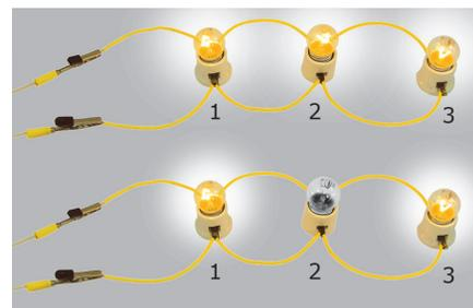
Considere a figura a seguir. Nela, a corrente em cada lâmpada é de 0,12 A. Você já sabe que, na associação em paralelo, as lâmpadas funcionam de forma independente. Assim, as correntes que passam pelos pontos M, N e P são, respectivamente, 0,36 A (corrente total), 0,24 A (corrente das lâmpadas 2 e 3) e 0,12 A (corrente da lâmpada 3), conforme mostrado a seguir.
