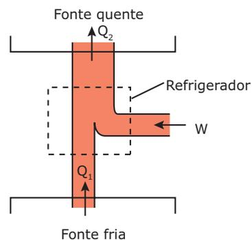
Figura 4: Transferência de calor em um refrigerador térmico.
