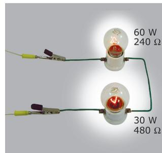
O circuito é um divisor de tensão. Como  $R_2 = 2R_1$ , temos que  $V_2 = 2V_1 \Rightarrow V_1 = 40\ V$  e  $V_2 = 80\ V$ . As potências reais das lâmpadas podem ser calculadas por  $P = V^2/R$ . Assim,  $P_1 = 40^2/240 \cong 6,67\ W$  e  $P_2 = 80^2/480 \cong 13,3\ W$ . Ou seja, a lâmpada de menor potência nominal está dissipando a maior potência real (brilha mais).
